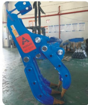
08款 自重(Weight) : 900kg 匹配(Excavator weight range) : 20-30吨挖掘机 开口(Max open jaw size) : 2000mm
